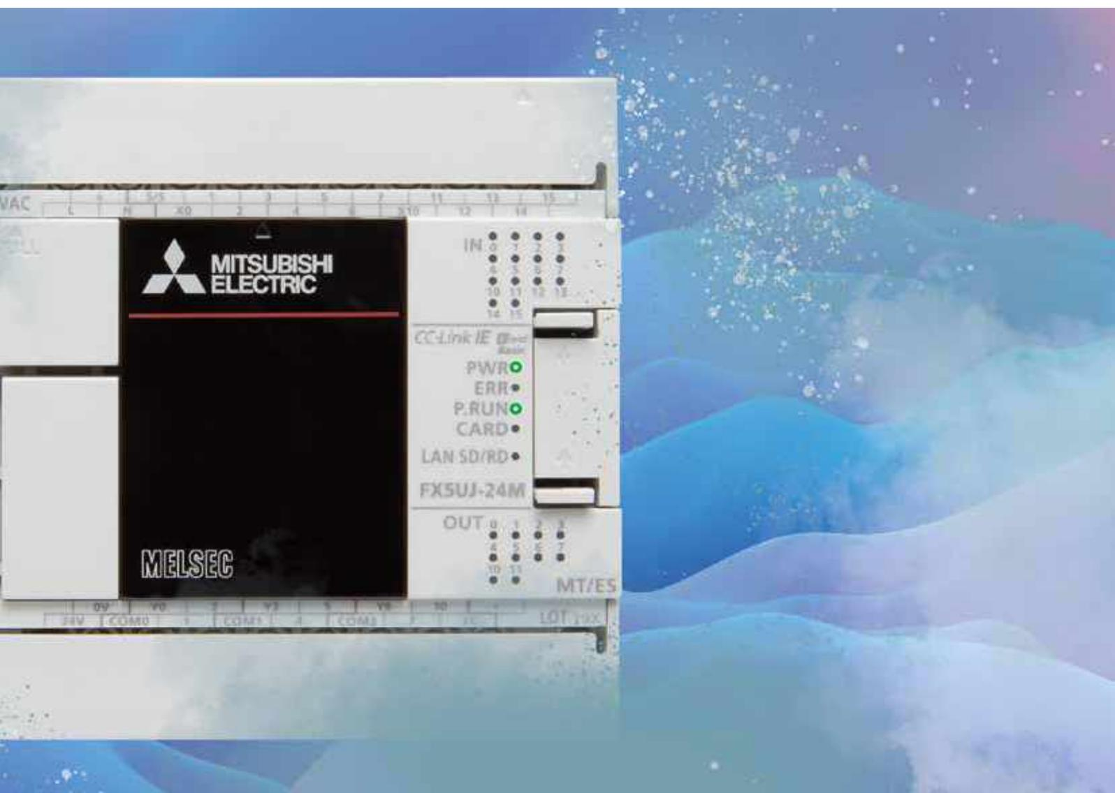
Possui várias funções integradas tais como contadores de alta velocidade, saídas por impulso para tarefas de posicionamento de alta *performance*, um interface Ethernet com possibilidade de acesso remoto e de configuração, sendo o software de programação o GX Works3, tal como no FX5U.
