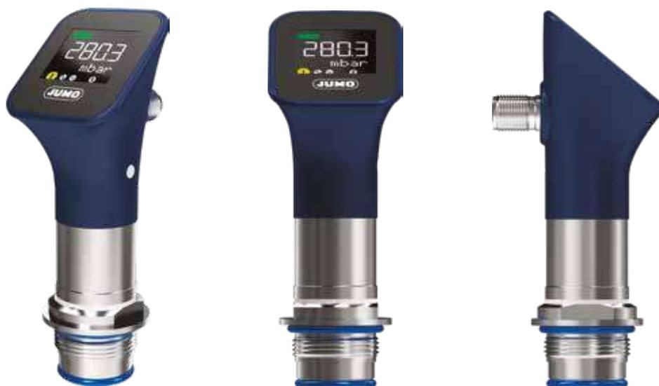
O transmissor de pressão JUMO DELOS S02 é um dispositivo inovador de alta precisão, concebido para medir pressões relativas e absolutas em meios líquidos e gasosos. As gamas de medição variam entre 0,1 a 100 bar para pressão relativa e 0,4 a 60 bar para pressão absoluta.
