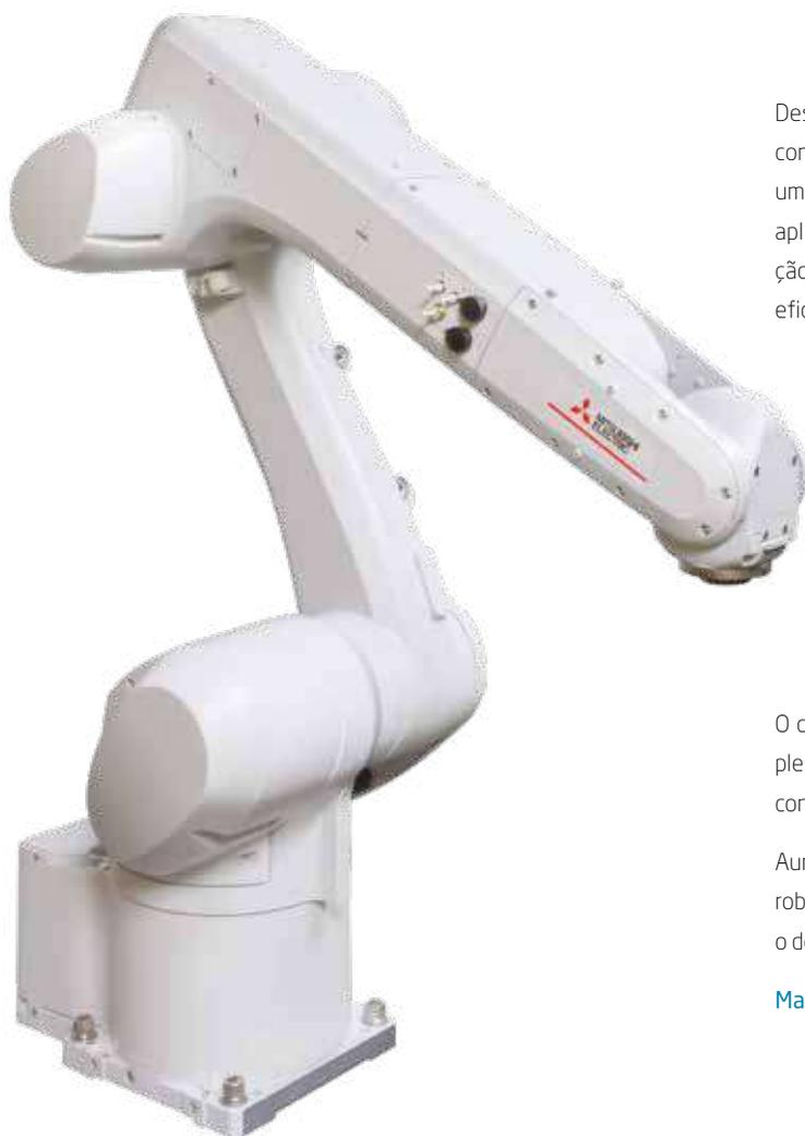
Descubra o RV-12CRL da Mitsubishi Electric: um robô compacto, mas com um desempenho impressionante. Com uma carga útil de 12 kg e um alcance superior a 1,4 metros, redefine a versatilidade em diversas aplicações industriais. Ideal para processos de *pick and place*, paletização, manuseamento de componentes e montagem, este robô eleva a eficiência ao combinar maior velocidade com força no pulso.
