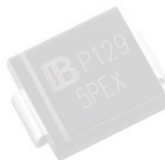
A Rutronik adicionou a nova série de díodos YAGEO TVS 5.0SMDJ ao seu portefólio de componentes qualitativos de proteção contra surtos. Os produtos são feitos de um pacote DO-214AB de alta fiabilidade, que juntamente com a capacidade especial de manipulação de energia dos díodos garante uma maior proteção dos circuitos. E têm um tempo de resposta particularmente curto. Além disso, absorvem de forma fiável picos de alta tensão
