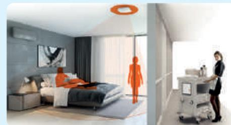
Em hotéis, por exemplo, os sensores inteligentes detetam em que quartos os hóspedes se encontram. Se não existirem hóspedes, a iluminação e o ar condicionado são automaticamente regulados. Esta ação pode poupar uma grande quantidade de energia e tornar os serviços mais rápidos e eficientes.
