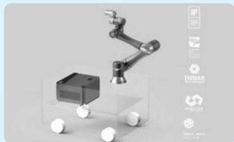
A série móvel TM-M da Techman Robot, composta pelas versões TM5M-700, TM5M-900, TM12M-1300 e TM14M-1100, são alimentados a 20-60 VDC, tornando-os compatíveis com a maioria das marcas de AGVs e outros veículos móveis. Através do uso dos "TM – Landmark", os robots móveis podem orientar-se num espaço 3D, como uma sequência de dados automática, para servir várias máquinas, permitindo que os TM-M
