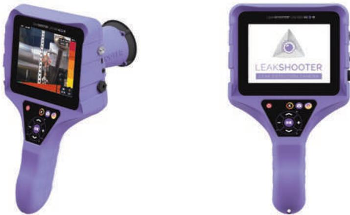
Quando a câmara do Leakshooter chega perto de uma fuga, um alvo amarelo dinâmico aparece no grande display a cores e o alvo fica vermelho e diminui à medida que se aproxima da fonte da fuga, sendo possível nesse momento fotografar e salvar a localização precisa da fuga.
