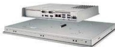
O computador industrial de painel tátil modular com processador Intel Core i3/i5/i7 de 8.ª geração, possui um *design* flexível da tecnologia modular permite que os utilizadores alterem o tamanho do monitor ou a *performance* do CPU do computador de acordo com suas exigências de utilização.
