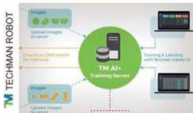
O TM AI+ Training Server é um *software* que permite aos utilizadores processarem uma grande quantidade de amostras, recolhidas pelo sistema de visão do robot e construir um modelo de *deep learning*, que irá permitir ao robot executar tarefas de diferenciação com base no que aprendeu.
