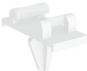
A solução mais rentável para fixação de cabos ou tubos em placas metálicas, ou bandejas de cabos. Pode ser utilizado em perfis de placas metálicas com medidas compreendidas entre: 0,6 a 1,2 mm, e em furos de 5,5-6,5 mm Ø.
