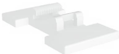
A ST-BASE é destinada a ser instalada com a aplicação da cola prego e deixando-a repousar durante pelo menos 24 horas antes de proceder à fixação de cabos ou abraçadeiras Super-T.
