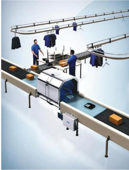
**Figura 2.** Túnel de leitura RFID para produtos embalados.
