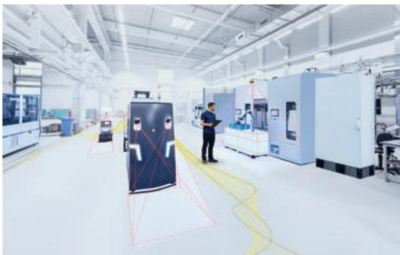
O safeVisionary2 baseia-se na tecnologia de tempo de voo e possui certificação PL c (*Performance Level c*), permitindo a perceção segura a três dimensões do ambiente aumentando, deste modo, quer a segurança quer a eficiência das aplicações.
