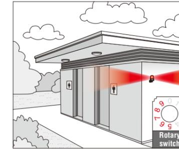
Las señales visuales empezarán a funcionar inmediatamente cuando se encienda la baliza SF. Así se evita tener que disponer de un dispositivo para activar las funciones operativas para este tipo de aplicación.
