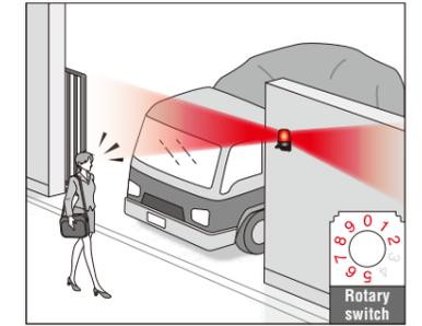
La baliza SF se instala en una entrada para avisar a los peatones del paso de vehículos grandes. Se usa un temporizador para atenuar la luz durante las horas de oscuridad para no cegar a los conductores.
