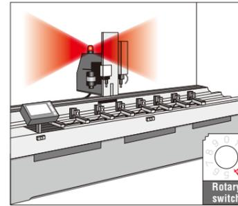
La baliza SF se monta sobre una máquina de llenado para indicar los diversos estados de funcionamiento mediante distintos ajustes de giro y destello. Seleccione entre 22 patrones de luz para proporcionar señales visuales inequívocas.
